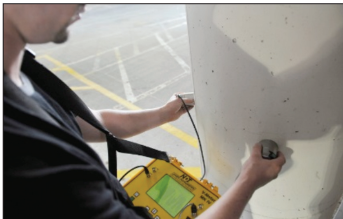
V-Meter MK IV оценка круглого бетонного столба
