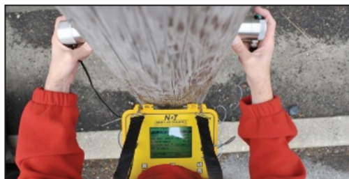
V-Meter MK IV Используется для контроля деревянной опоры
